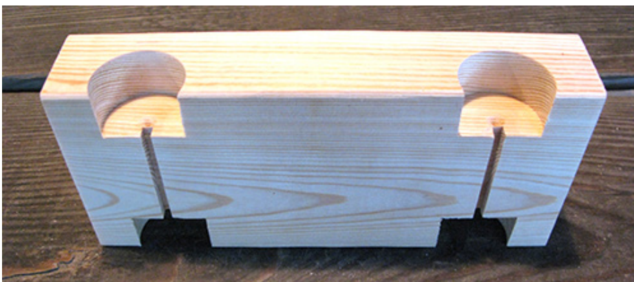
キットFのシャーシです。あらかじめホイールハウスと車軸の溝が掘られています。
