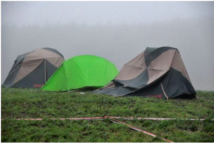
◎比較的安いのでよく使用されている某C社製テント(左・右)。強風の下では構造上このようにポールが当初の形状を保つことができなくなってしまう。
